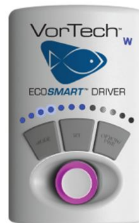
La ilustración muestra el driver EcoSmart en el Modo EcoSmart (dial de control lila); los LEDs tercero y cuarto iluminados muestran que el driver está ajustado en NTM; los LEDs más ténues muestran la velocidad ajustada.
