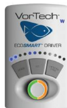
Driver en la configuración de la velocidad del Modo nocturno ajustada a una velocidad más baja y señalando la velocidad por defecto ajustada en 3.
