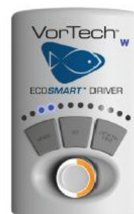
Driver en el Menú principal del Modo de Configuración, en la opción de ajuste de la velocidad del Modo Nocturno.
